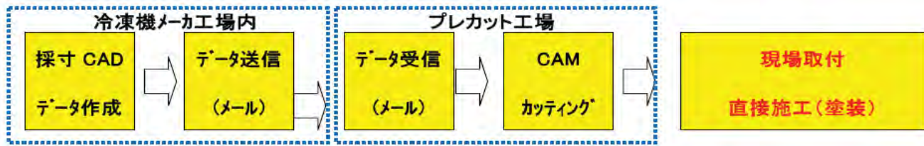
冷凍機プレカット作業フロー
